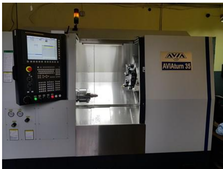
Rys. 4-31 Tokarka cyfrowa AVIAtum35
