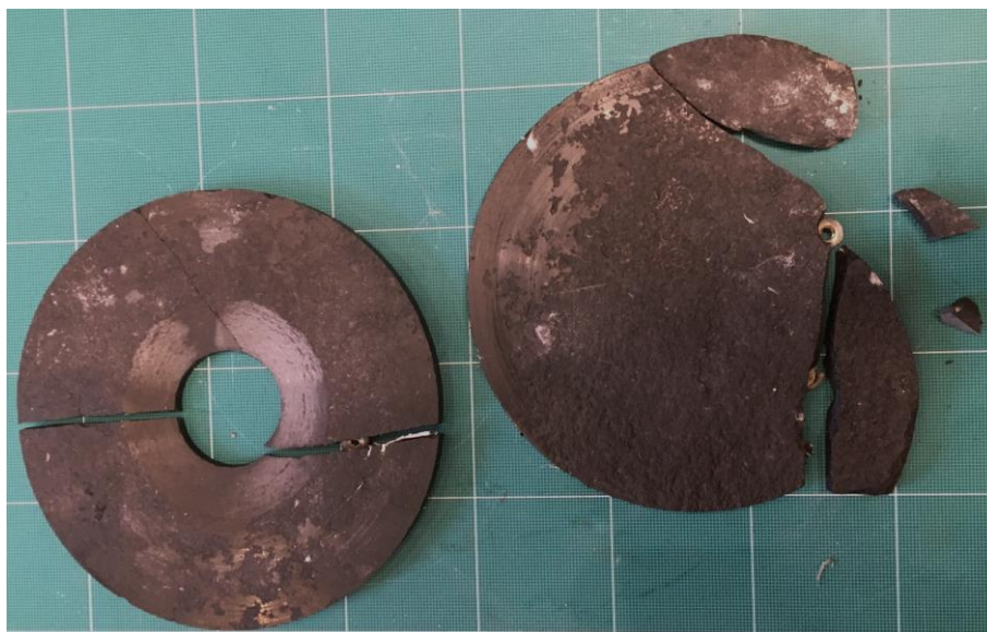
Rys. 4-73 Uszkodzone tarcze BZ1
