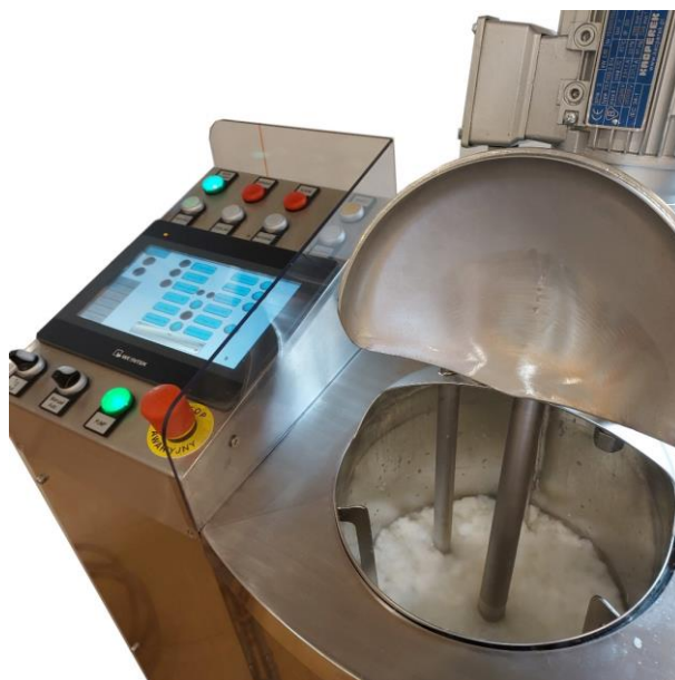
Rys. 4-83 Masa celulozowa podczas hydrolizy
