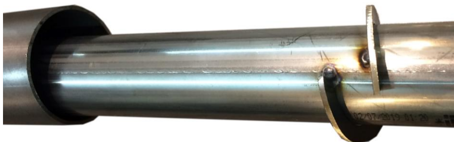
Rys. 4-53 Przegroda mieszająca w wymienniku
