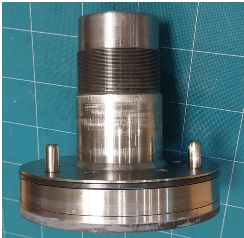
Rys. 4-22 Fotografia statora po wykonaniu badań
