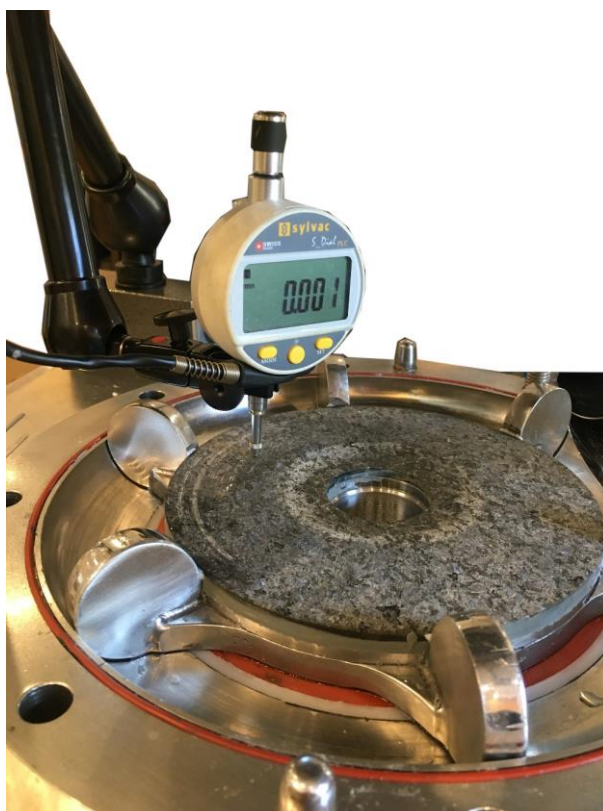
Rys. 4-86 Pomiar odchylenia tarczy po dotarciu
