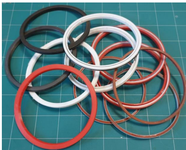
Rys. 4-39 Nieudane próby doboru uszczelniacza
