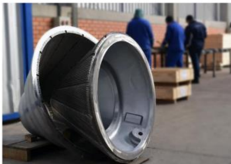
Rys. 2-28 Zdjęcie zintegrowanego garnituru nożowego młyna stożkowego (152)
