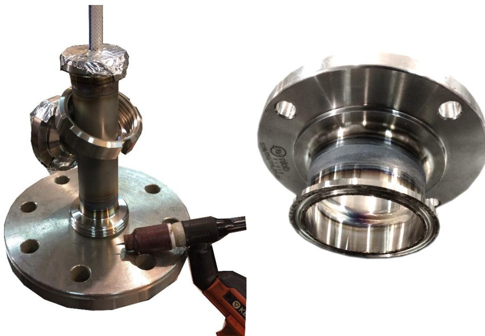
Rys. 4-57 Spawanie z wypełnieniem gazem
