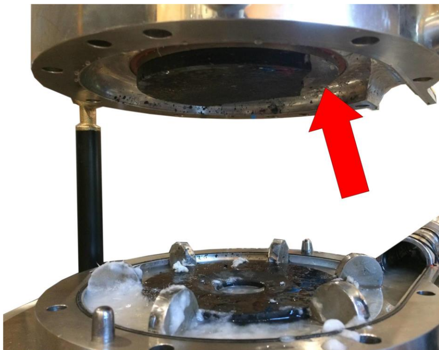
Rys. 4-72 Uszkodzenie tarcz w młynie
