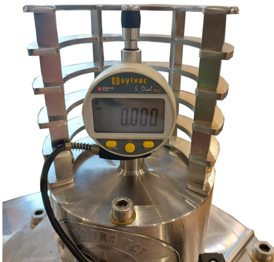
Rys. 4-23 Czujnik pozycji statora
