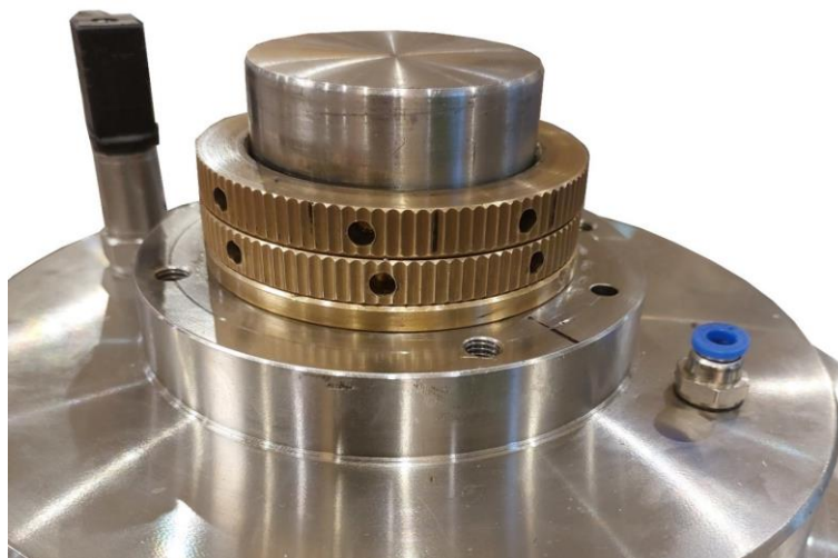
Rys. 4-28 Widok elementu regulacyjnego ze zdjętą głowicą
