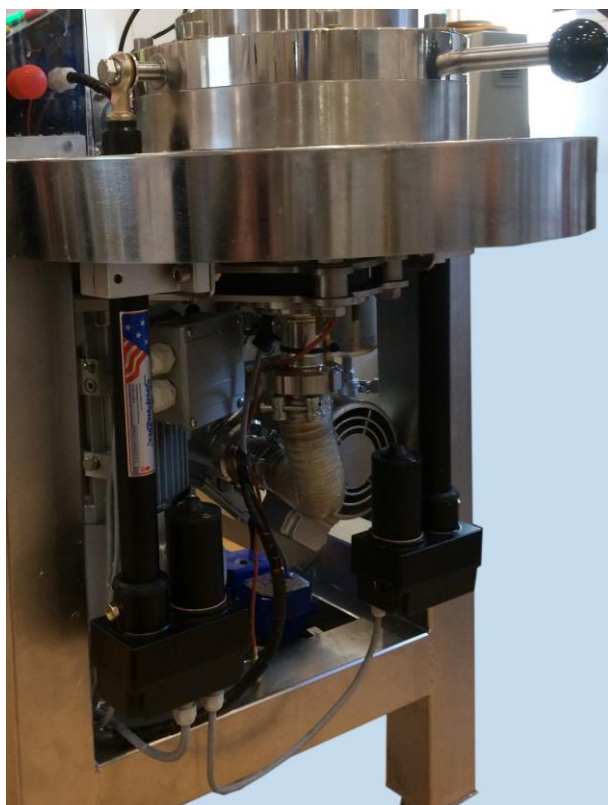
Rys. 4-60 Siłowniki podnoszenia korpusu górnego
