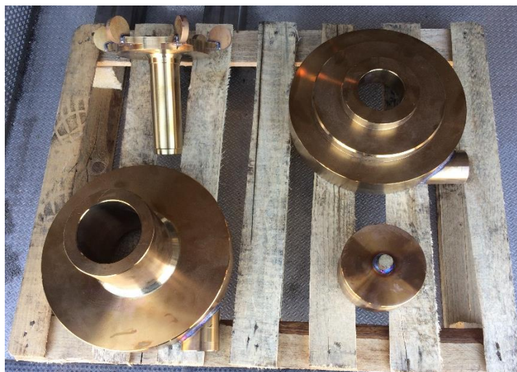
Rys. 4-29 Części młyna po obróbce termicznej
