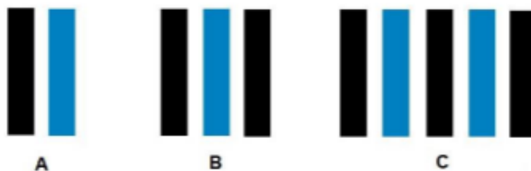
Rys. 2-24 Podstawowe rodzaje młynów tarczowych, a – dwutarczowy, b – podwójny, c– wielotarczowy [212]
