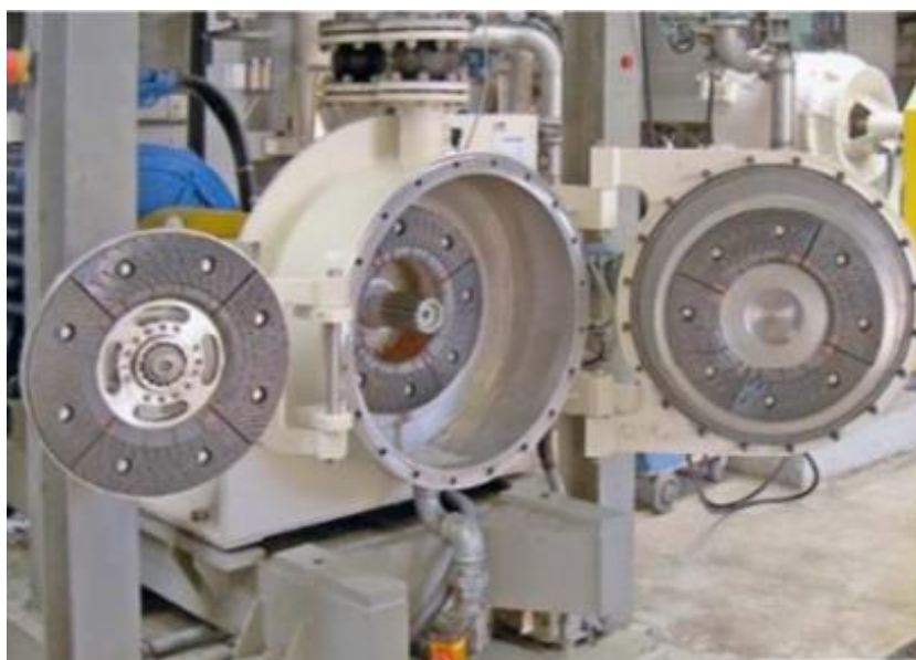
Rys. 2-25 Fotografia podwójnego młyna tarczowego z rozłożonymi tarczami [242]
